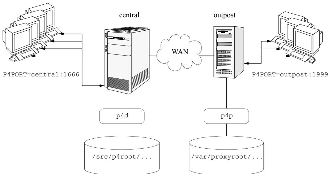
この図において、リモート開発拠点のユーザによって要求されたファイル・リビジョンは、まず中央の PERFORCE サーバ (central で動作している p4d) から取り出され、比較的遅い WAN を通じて転送されます。しかし、同一のリビジョンに対する次の要求は、PERFORCE プロキシ (outpost で動作する p4p) で処理されます。これは、リモート開発拠点の LAN を使用した転送であり、WAN におけるネットワーク・トラフィックと中央サーバの CPU 負荷の両方を軽減していることになります。
