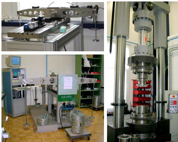
Magtrol SA社のトルク校正設備
