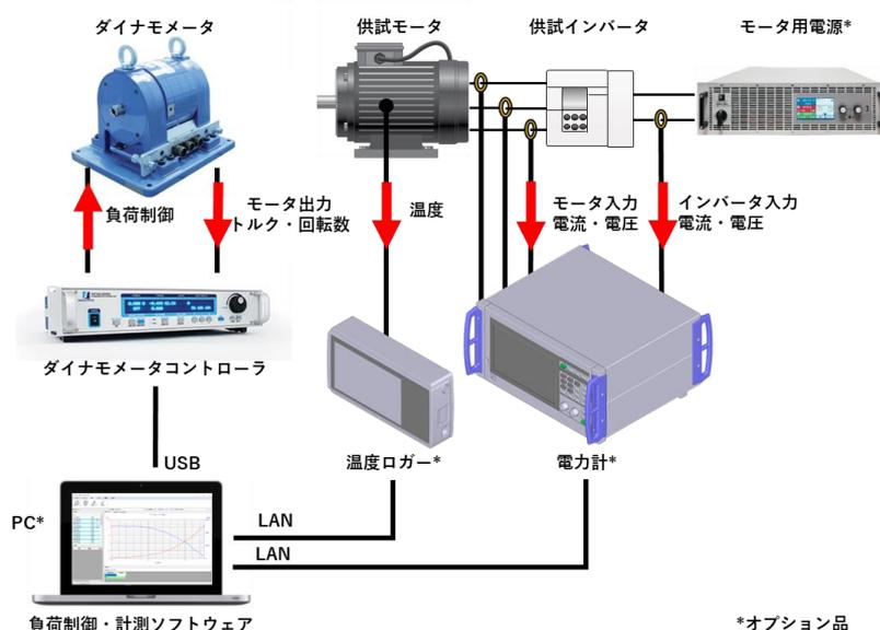
モータトルク計測に必要なアイテムが全てセット
