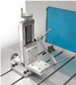
上下・水平調整、斜めのボルトで固定
