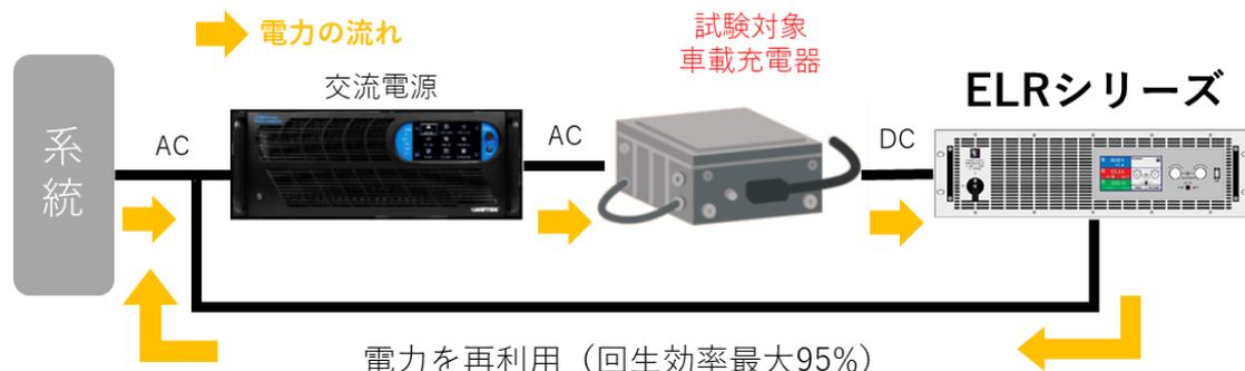
※掃引した電力を試験用交流電源の入力側に回生し、再利用します。
