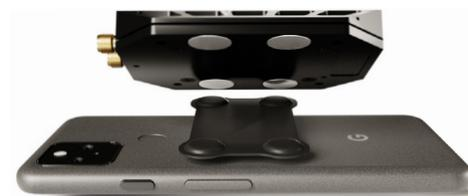
PRISMはモバイルデバイスに簡単にマウントでき、重量は170グラム
