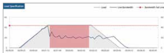
攻撃トラフィックを混入 攻撃はブロックしたがパフォーマンス劣化
