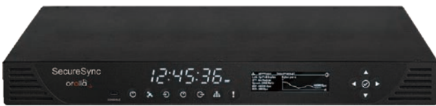
SecureSync フロントパネル
