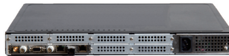
SecureSync2400 リアパネル オプションスロットに任意の2つ、 もしくは6つのオプションモジュールを組み込みカスタマイズ可能
