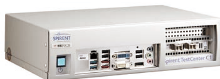
Spirent C1 ポータブルアプライアンス サイズ: 1U 311(W) x 241(D) x 87(H)mm 重量: 4.5kg
