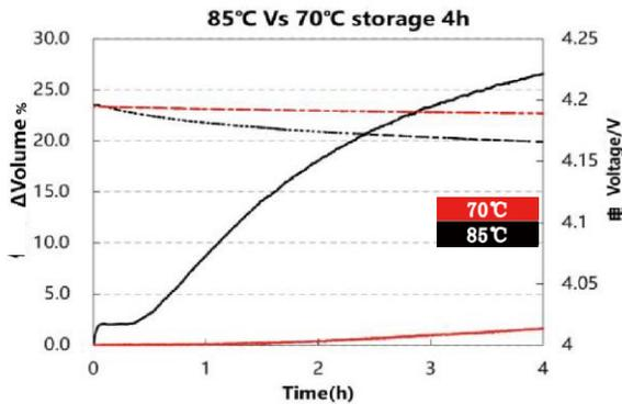
満充電時のセルを70°Cと85°Cで静置したとき、温度が高い85°Cの方が経過時間の体積増加と電圧降下が顕著にみられました。
