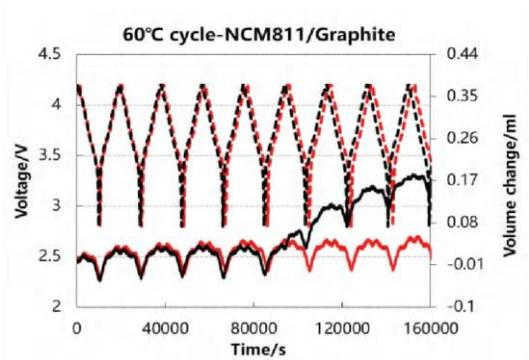
異なるNCM811(正極材料)を用いたセルの充放電サイクル試験を実施したところ、6サイクル目以降で体積変化に違いがみられました。
