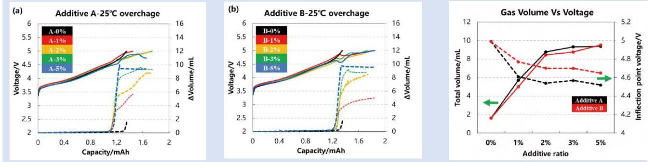
(a) (b)電解液に、添加剤Aと添加剤Bを添加したセルにおける過充電時の充電曲線(実線)と体積変化(点線)を示しています。
