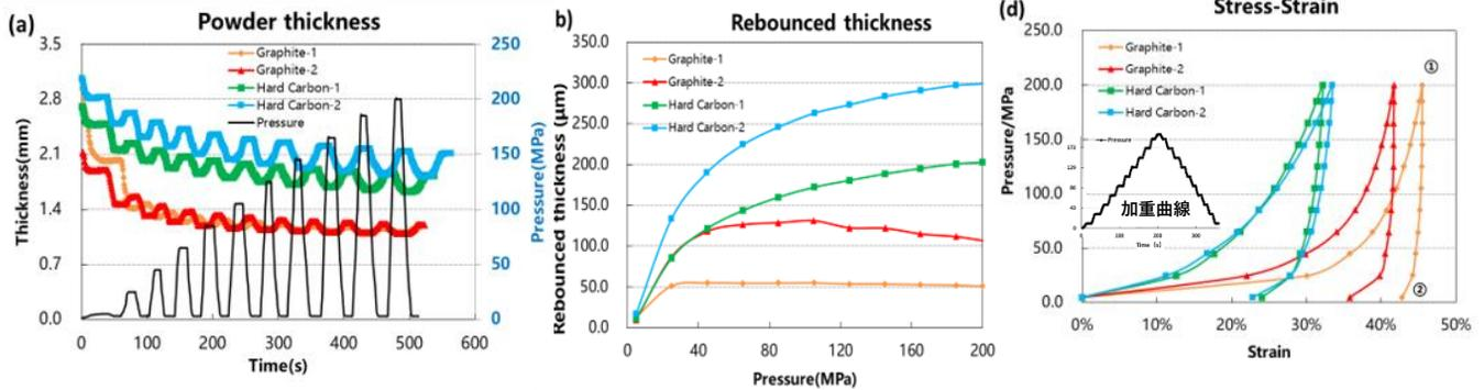
ステップ状の加圧によりグラファイトに比べてハードカーボンの変形幅が小さいことが分かりました。抵抗値の安定性を取るため圧縮試験の際にステップ状の加圧を行ったが一般的な応力-ひずみ曲線と同等の結果が得られました。
