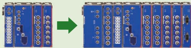
計測モジュールを追加してチャンネル増設
